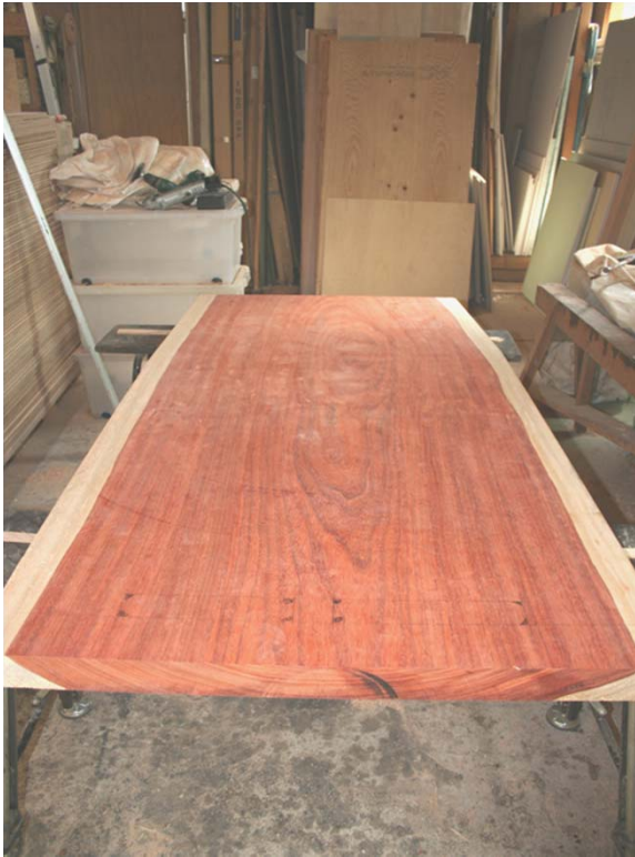
脚が取りつくホゾ穴加工前の板で、テーブルの裏面になります。
